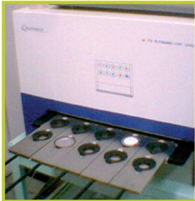
Figura 8 - IRP Casaccia, Laboratorio di sorveglianza ambientale: strumentazione di misura dell'attività alfa e beta totale
