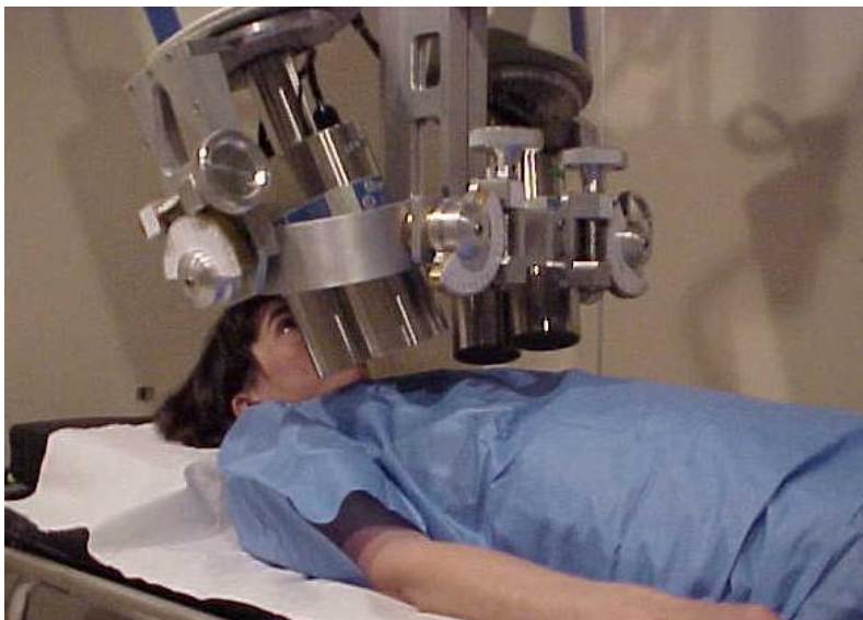
Figura 7 - In vivo counting: sistema di misura polmonare a bassa energia in dotazione ai Laboratorio ENEA IRP Casaccia
