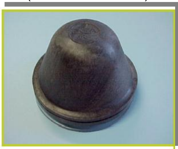
Figura 9 - Dispositivo per il campionamento passivo del radon (brevetto ENEA MI2006A000703)
