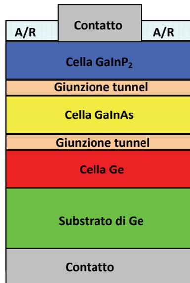
**Fig. 12 – Rappresentazione indicativa (non in scala) di una sezione trasversale della cella a giunzione tripla della Spectrolab che ha ottenuto nel 2006 il record di efficienza sotto illuminazione di 240 soli (A/R sta per strato antiriflesso)**
