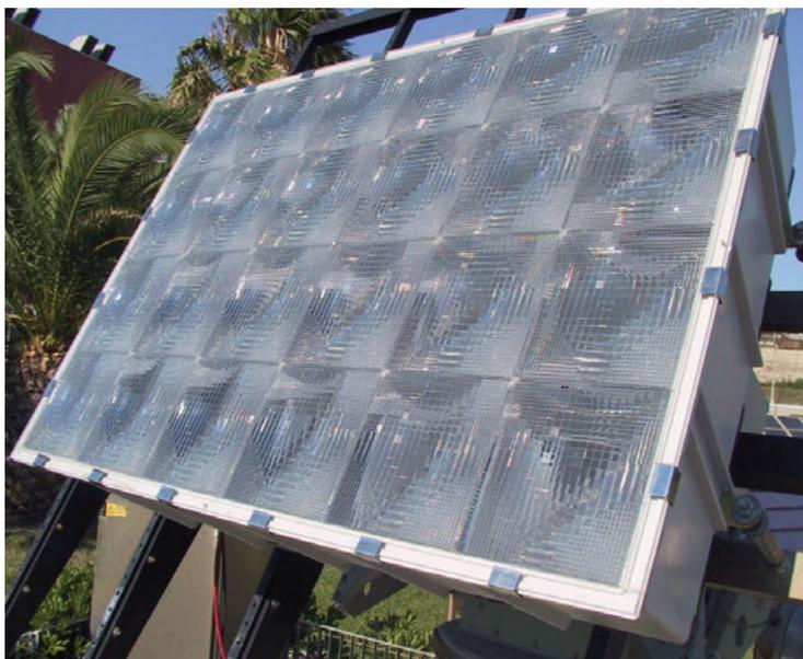
Fig. 55 – Modulo di concentratore a lenti prismatiche per Phocus (foto da archivio ENEA)
