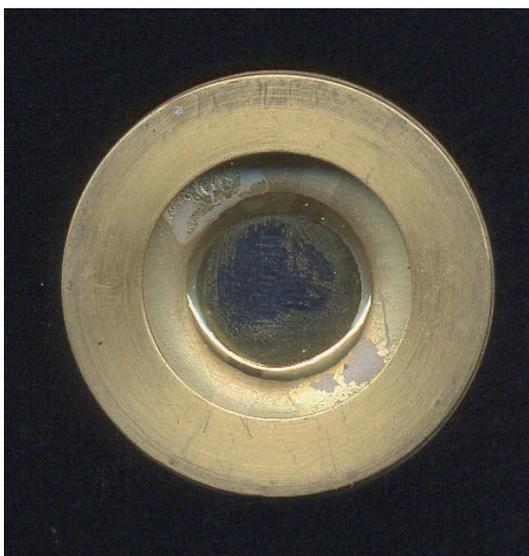
I rivelatori di radiazioni nucleari erano anche molto sensibili alla radiazione luminosa tanto che essi venivano usati nelle misure di spettrometria rigorosamente all'oscuro, mantenendoli in una custodia opaca per schermanli dal disturbo provocato dalla luce. Nel 1969, su alcuni campioni di questi rivelatori furono effettuate misure di fotorisposta spettrale e di effetto fotovoltaico in occasione della tesi di laurea in fisica dello studente M. Russo (relatore prof. A. Sanò, Università di Roma).
