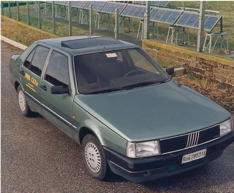
**Fig. 46 – Prototipo di automobile FIAT Croma dotata di tettuccio apribile fotovoltaico in circolazione nel 1991**
