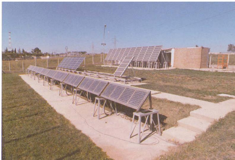
**Fig. 22 – La stazione sperimentale fotovoltaica del CSN Casaccia nel 1980. In primo piano si vede l'impianto della Solarex e sullo sfondo quello dell'ANSALDO, mentre l'impianto ARCO Solar è quello più in alto**
