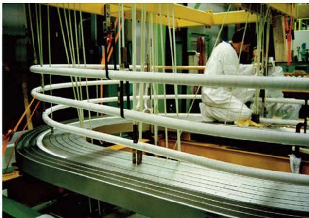
**Figura 71 - Trasferimento del conduttore nella doppia galletta del prototipo delle bobine del campo magnetico toroidale per ITER realizzata da ASG Superconductors (Genova). La saldatura dei coperchi delle sedi del conduttore è stata effettuata con un sistema completamente automatizzato basato su saldatura laser con controllo di direzione dalla RTM di Vico Canavese (Ivrea).**
