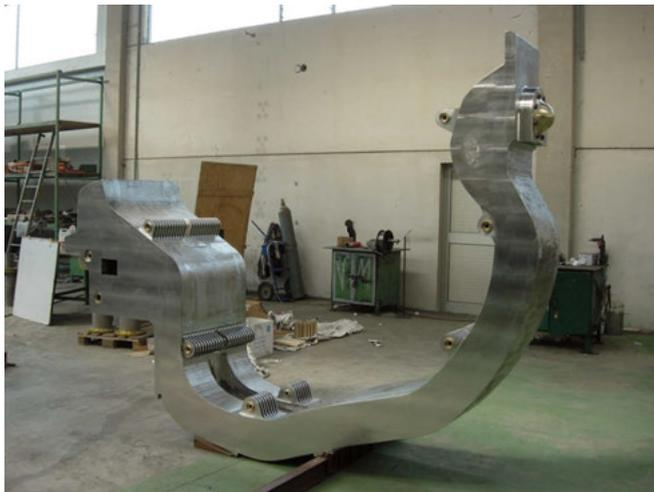
**Figura 79 - Prototipo della cassetta del divertore di ITER realizzato da ANSALDO Ricerche (Genova) e da SIMIC di Camerana (Cuneo).**
