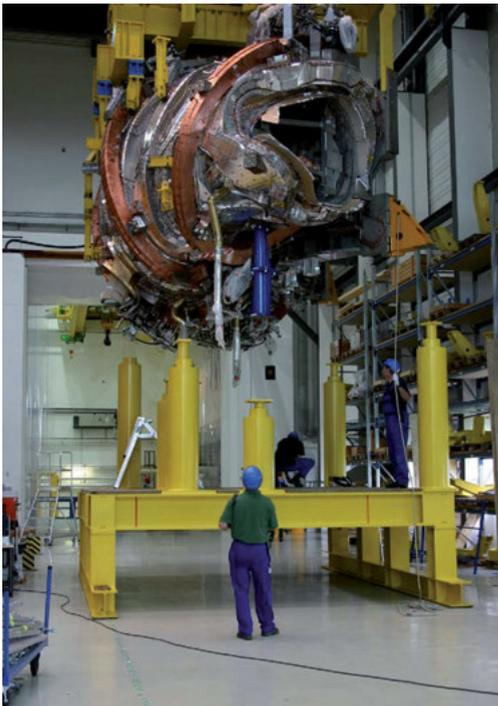
**Figura 68** - Bobine del magnete superconduttore per Wendelstein 7-X realizzate da ASG Superconductors di Genova (Gruppo Malacalza).
