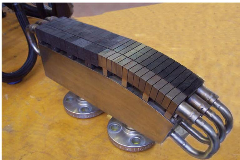
Figura 77 - Prototipo del Inner Vertical Target del divertore di ITER, dopo le prove di elevato flusso termico (fino a 20 MW/m<sup>2</sup>) delle reali condizioni di esercizio, eseguite per la qualifica europea (realizzato da Ansaldo Ricerche e ENEA nell'ambito di un Accordo di Collaborazione per lo sviluppo e fornitura del divertore di ITER).
