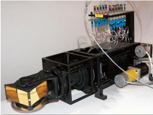
**Figura 61 - Prototipo da laboratorio di IVVS utilizzato per verificare le prestazioni ottenute con riferimento a quelle richieste da ITER.**
