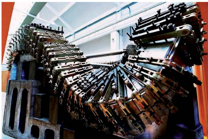
Figure 69 - Presso le officine di ASG Superconductors sono stati realizzati 30 avvolgimenti super conduttivi per le bobine del magnete superconduttore di Wendelstein 7-X
