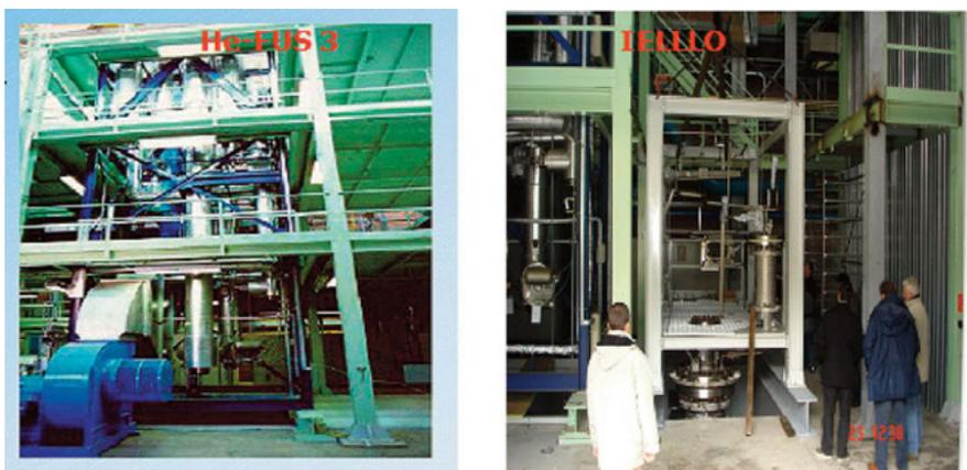
**Figura 46 – Impianto EBBTF (Euroean Breeding Blanket Test Facility), costituito dall'accoppiamento di un circuito a lega metallica liquida fluente Pb-16Li (IELLLO) con l'impianto a elio in pressione He-FUS3. EBBTF rappresenta l'apparato sperimentale di riferimento in Europa per le attività di sviluppo e qualifica, fino alla scala 1:1, dei sistemi di TBM per ITER, inclusi i principali circuiti ausiliari per l'estrazione ed il trattamento del trizio (Centro ENEA Brasimone).**
