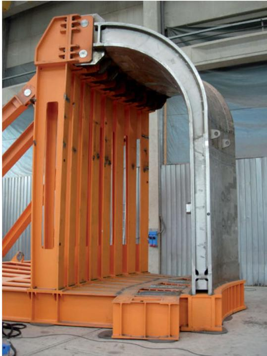
**Figura 78 - Prototipo della camera da vuoto di ITER durante la fase di fabbricazione, realizzato da ANSALDO Ricerche (Genova) e da SIMIC di Camerana (Cuneo).**
