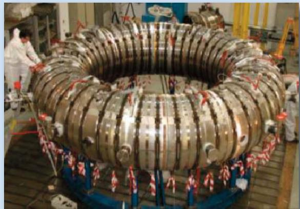
Figura 52 - Il montaggio del sistema di bobine controllate in feedback su RFX.
