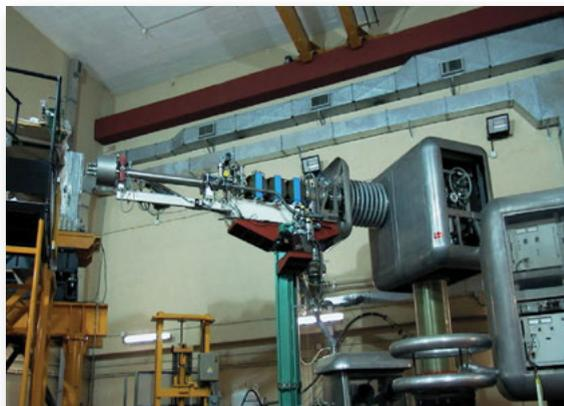
**Figura 47 - Il generatore di neutroni da 14 MeV FNG - Centro ENEA di Frascati.**
