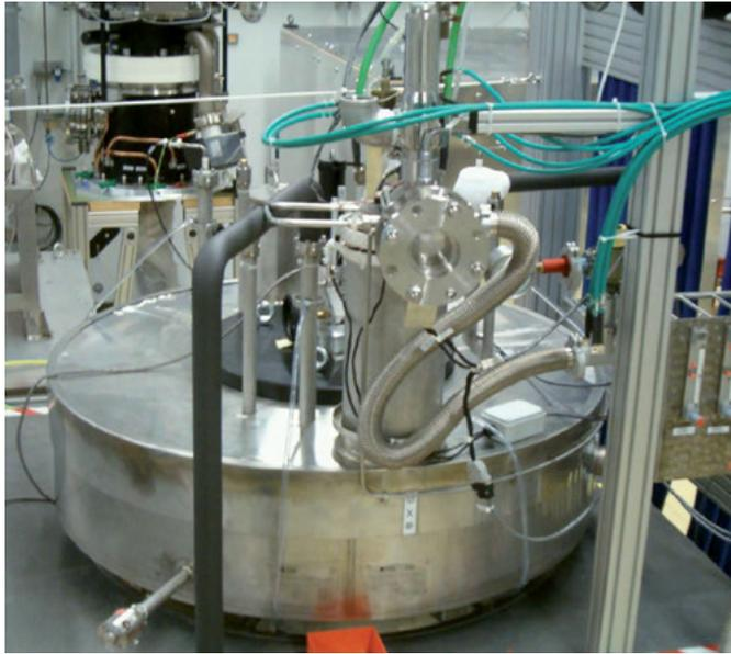
**Figura 83 - Magnete superconduttore in NbTi, criostato e sistema di controllo criogenico per il prototipo della sorgente del sistema di riscaldamento a radiofrequenza Electron Cyclotron (EC) di ITER, realizzato da ASG Superconductors. La densità di corrente nominale è  $\pm 88.3 \text{ A/mm}^2$  per la generazione di un campo magnetico di 7.2 T al centro della cavità e di 8.2 T sul conduttore.**
