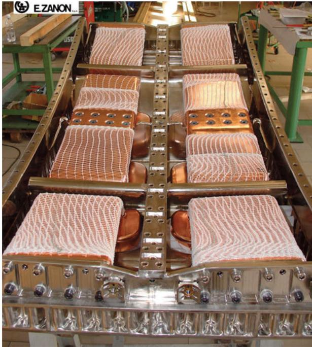
Figura 65 - Corpo principale dell'antenna ITER-like installata in JET per il sistema di riscaldamento del plasma a radiofrequenza ICRH, realizzata in Inconel 625/718 completa dei sistemi radianti di Inconel 625 con deposito elettrolitico di rame.
