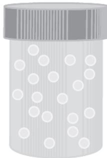
**Figura 8.23** - Disegno schematico di un rivelatore a bolle del tipo SDD®. Le bolle che si formano nel rivelatore per effetto dell'irraggiamento con particelle pesanti, possono essere rivelate e conteggiate durante l'irraggiamento mediante opportuni trasduttori, o contate successivamente in laboratorio con sistemi ottici
