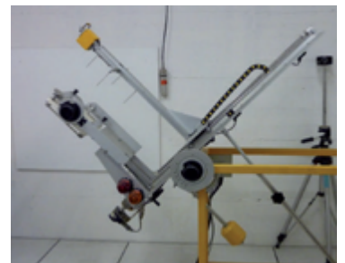
Irraggiamento angolare di dosimetri personali con sorgenti beta
