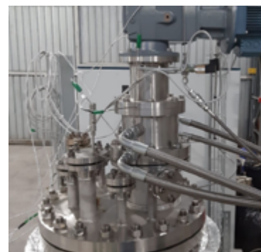
Impianto BID1: dettaglio della flangia di copertura e delle penetrazioni
