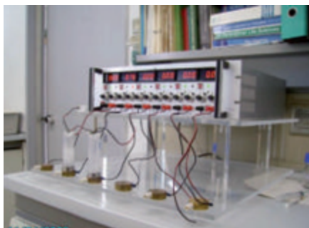
IRP Casaccia - Laboratorio misure in vivo (WBC): misura dell'attività nel polmone di radionuclidi con emissione X-gamma fra 10 keV e 100 keV)
