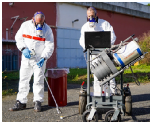
Spettrometria gamma per rivelare e quantificare in situ la presenza di gamma emettitori
