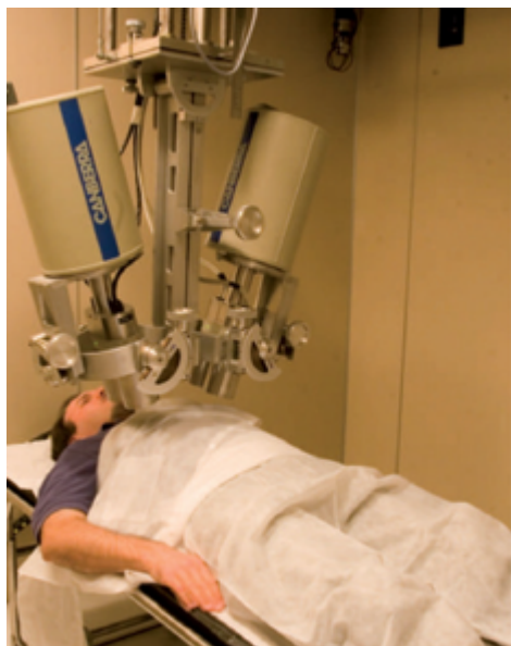
IRP Casaccia - Laboratorio misure in vivo (WBC): misura dell'attività nel polmone di radionuclidi con emissione X-gamma fra 10 keV e 100 keV)
