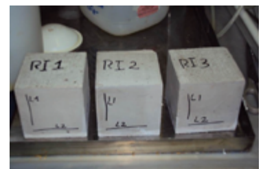
Provini cementizi per le prove di qualificazione
