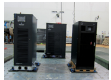
Test dinamico/funzionali su sistema sistemi UPS
