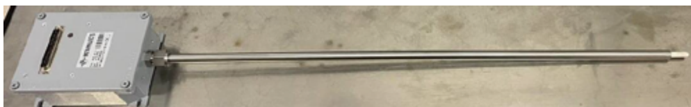
Sensore Ossigeno per impianto a piombo liquido
