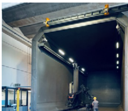
Camera del vuoto (sinistra) dell'impianto di saldatura a fascio elettronico e robot di saldatura (destra)
