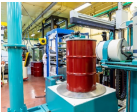
Tomographic Gamma Scanner – sistema sperimentale per tomografia gamma di rifiuti radioattivi condizionati
