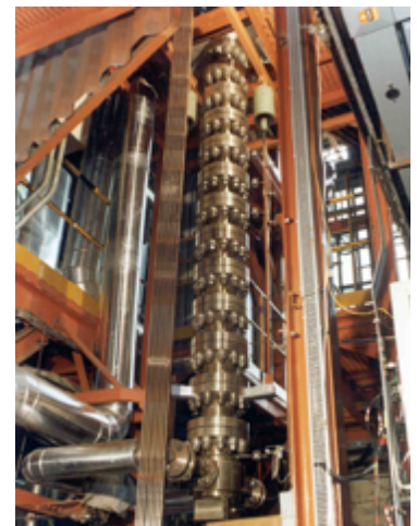
Prove di dry-out su un fascio di barre di un reattore BWR (10 MW; 70 bar)
