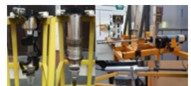
DRP hall – Bracci robotici e utensili di serraggio remotizzato
