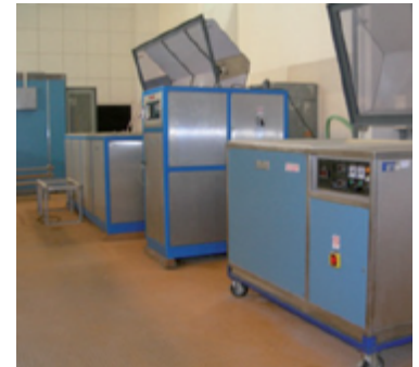
Camere climatiche e camere a nebbia salina per qualifica ambientale di componenti e sistemi nucleari
