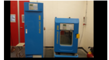
Camere climatiche per la stagionatura dei provini cementizi e per le prove che impiegano i cicli termici
