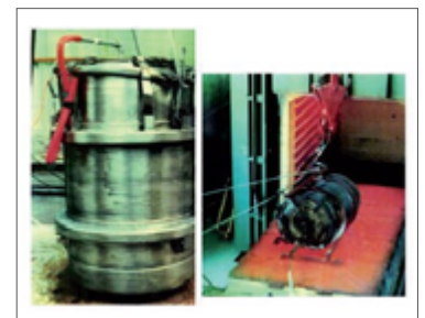
Contenitore di trasporto per soluzioni di plutonio dopo la prova di caduta da 9 m e invecchiamento termico a 800 °C per 30 minuti
