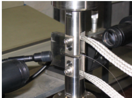
Test di tenacità ad alta temperatura e Test di avanzamento di cricca in regime di fatica
