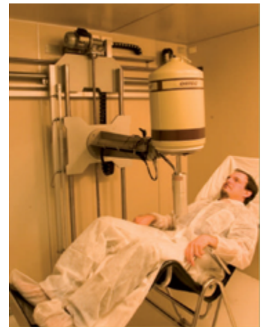
Whole Body Counter - Misure in vivo di contaminazione interna
