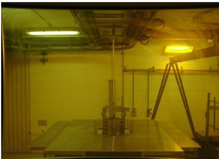
Fig. 4.1 - Vista della cella di irraggiamento dell'impianto "Calliope" - ENEA.
