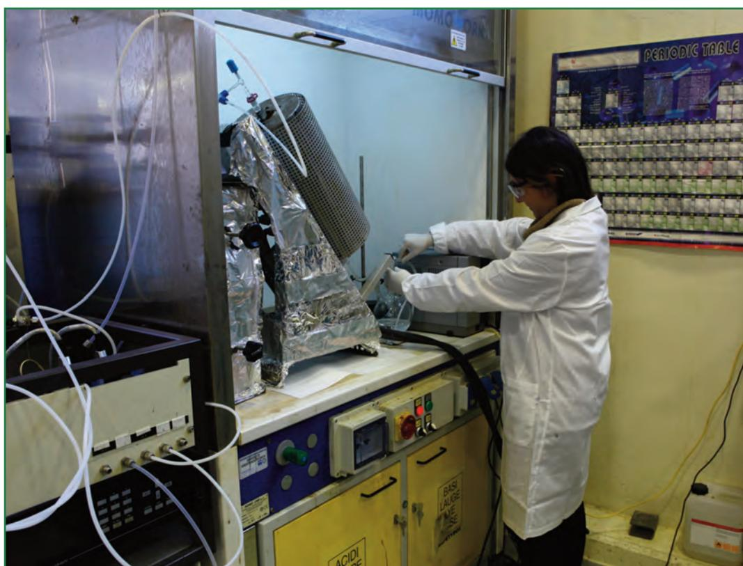
Forno tubolare (1200 °C) con reattore in quarzo per lo studio della reazione di metanazione da CO<sub>2</sub> e H<sub>2</sub> con flussimetri di massa e gascromatografo
