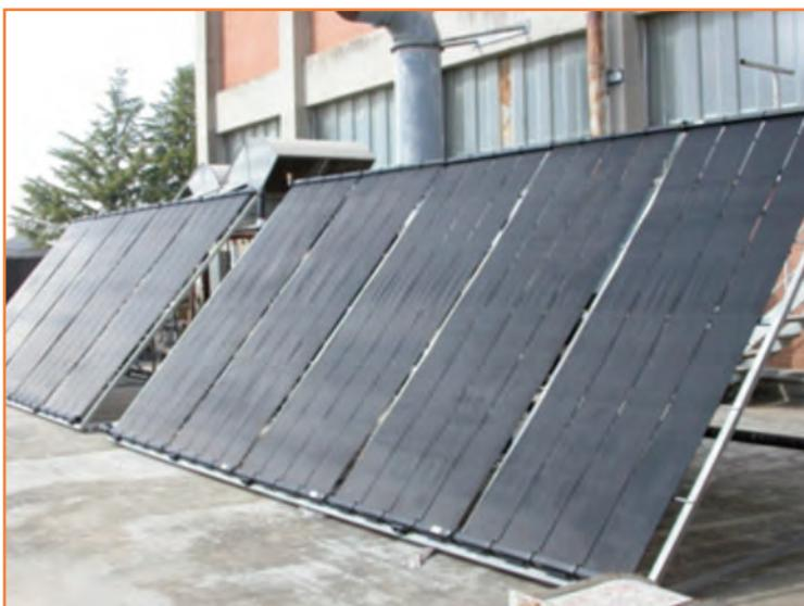
Facility per caratterizzazione pompe di calore elioassistite
