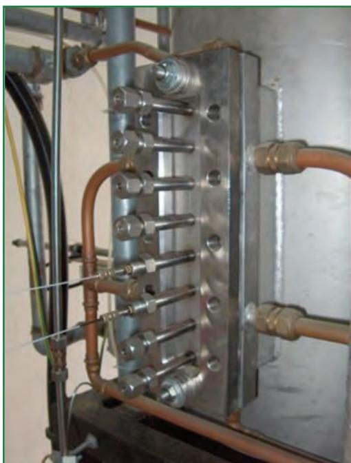
Accesso multi-strumentato con sensori ottici ODC<sup>®</sup> per misure di stabilità di combustione e velocità
