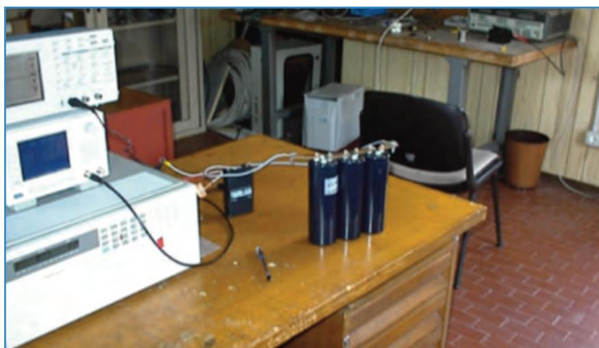
Celle di supercondensatori in prova
