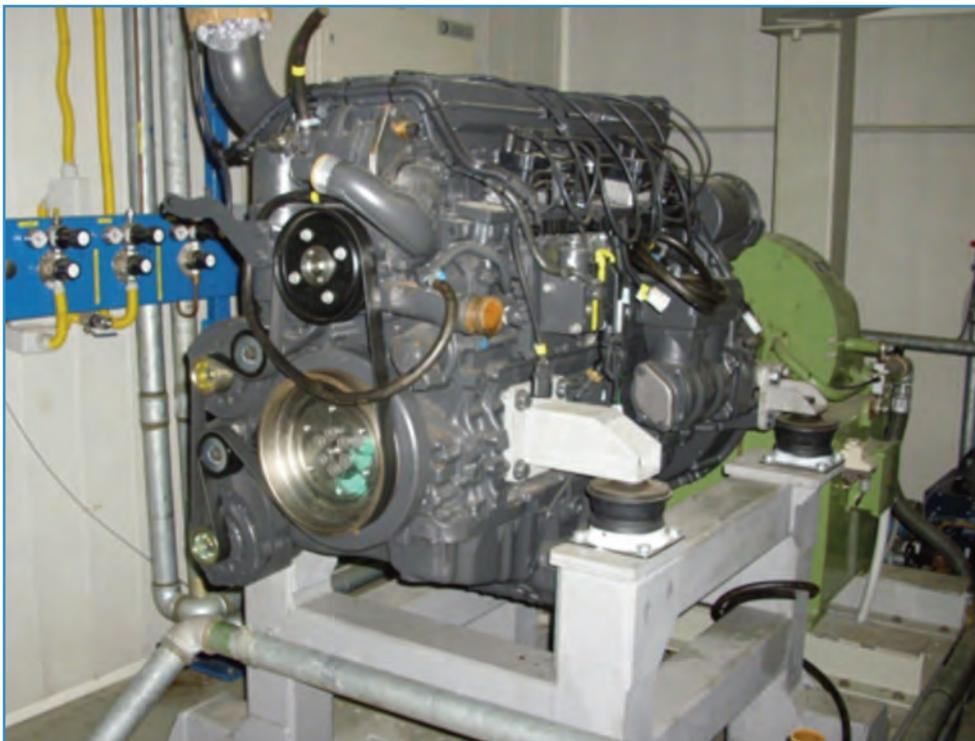
Freno idraulico da 250 kW
