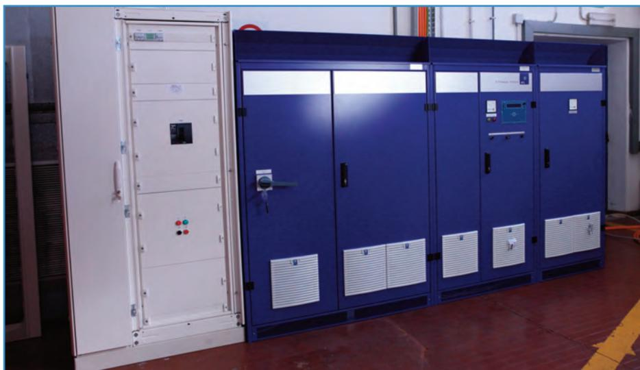
Laboratorio Prova Batterie – Ciclatore 250kW; 0-800V; 600A
