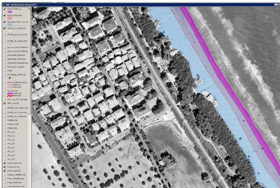
Figura 7.13 – Scenari di sommersione RSLR 2100 minimo e massimo lungo la fascia costiera abruzzese
