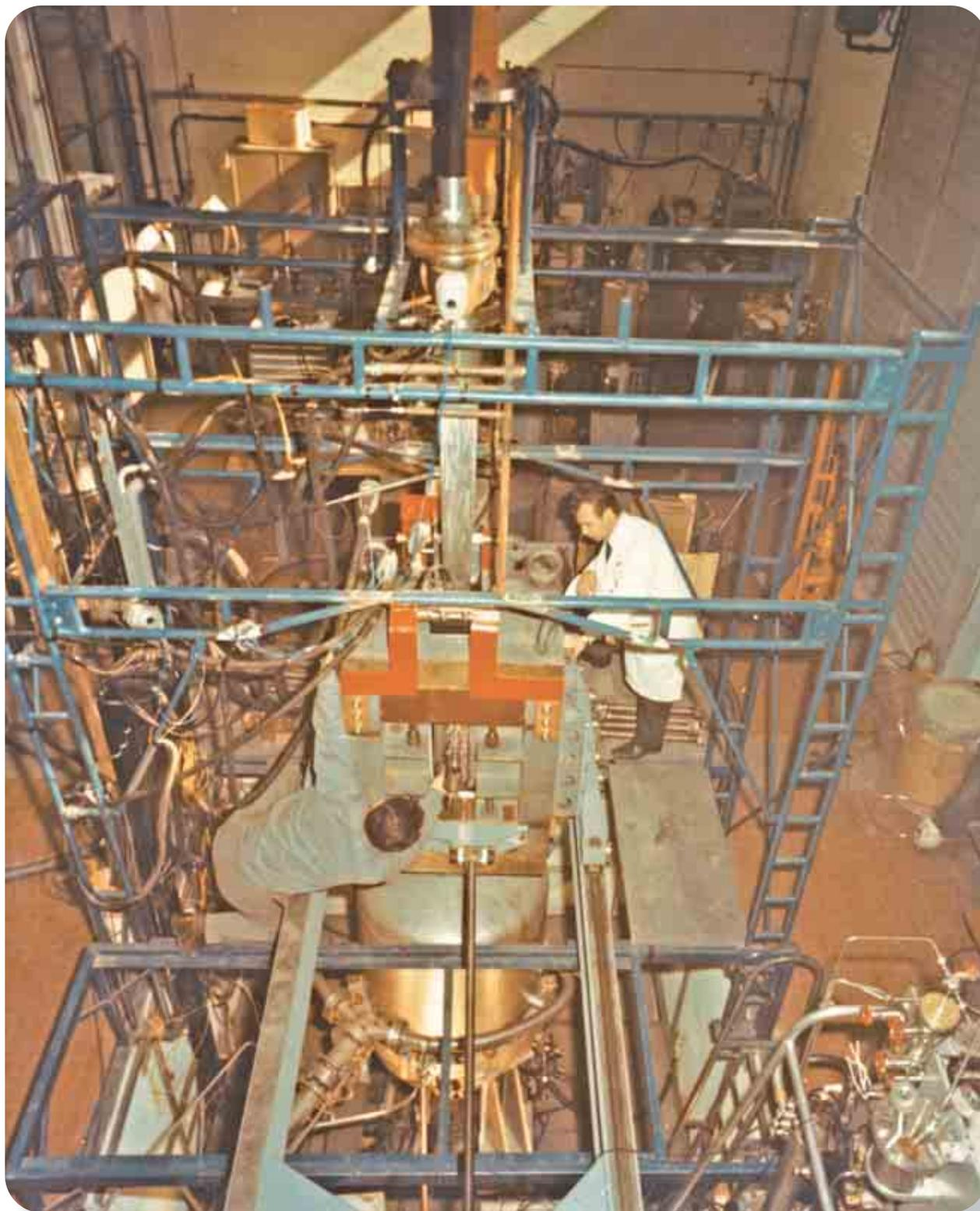
Esperimento di conversione diretta del calore in elettricità per via magnetoplasmadynamica.
