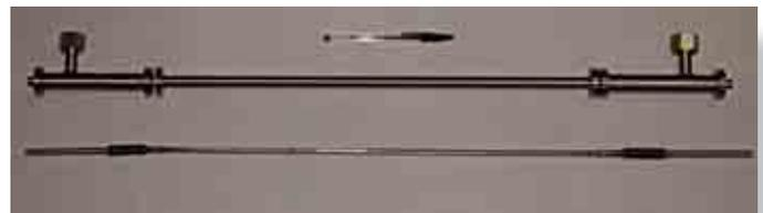
Reattore a membrana costituito da un involucro esterno in acciaio e da un tubo permeatore in lega Pd-Ag di diametro 6 mm, lunghezza 500 mm e spessore di parete 50  $\mu\text{m}$  (a destra).
