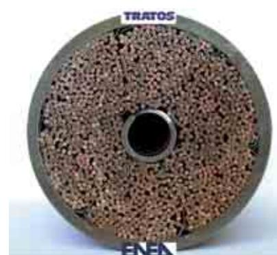
Prototipo di cavo superconduttore per il magnete toroidale di ITER - *Prototype of the superconducting cable for ITER toroidal magnet (TRATOS Cavi and ENEA).*
