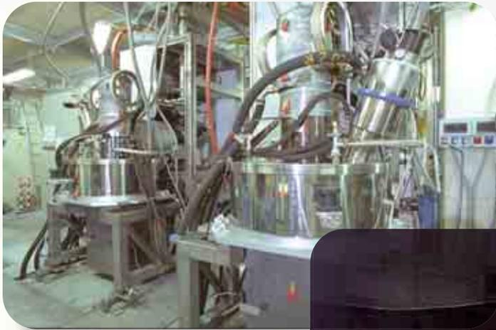
Due dei 4 gyrotron funzionanti nell'impianto ECRH di FTU.
