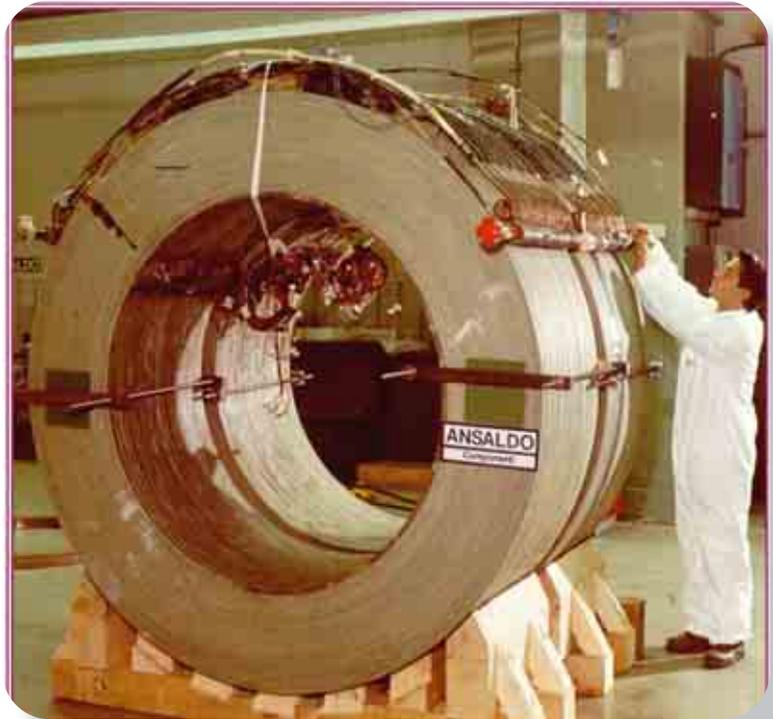
Primo magnete superconduttore di dimensioni rilevanti in Nb-Ti, progettato e costruito in Italia per la Test Facility SULTAN (Villigen, Svizzera) nel 1980.
