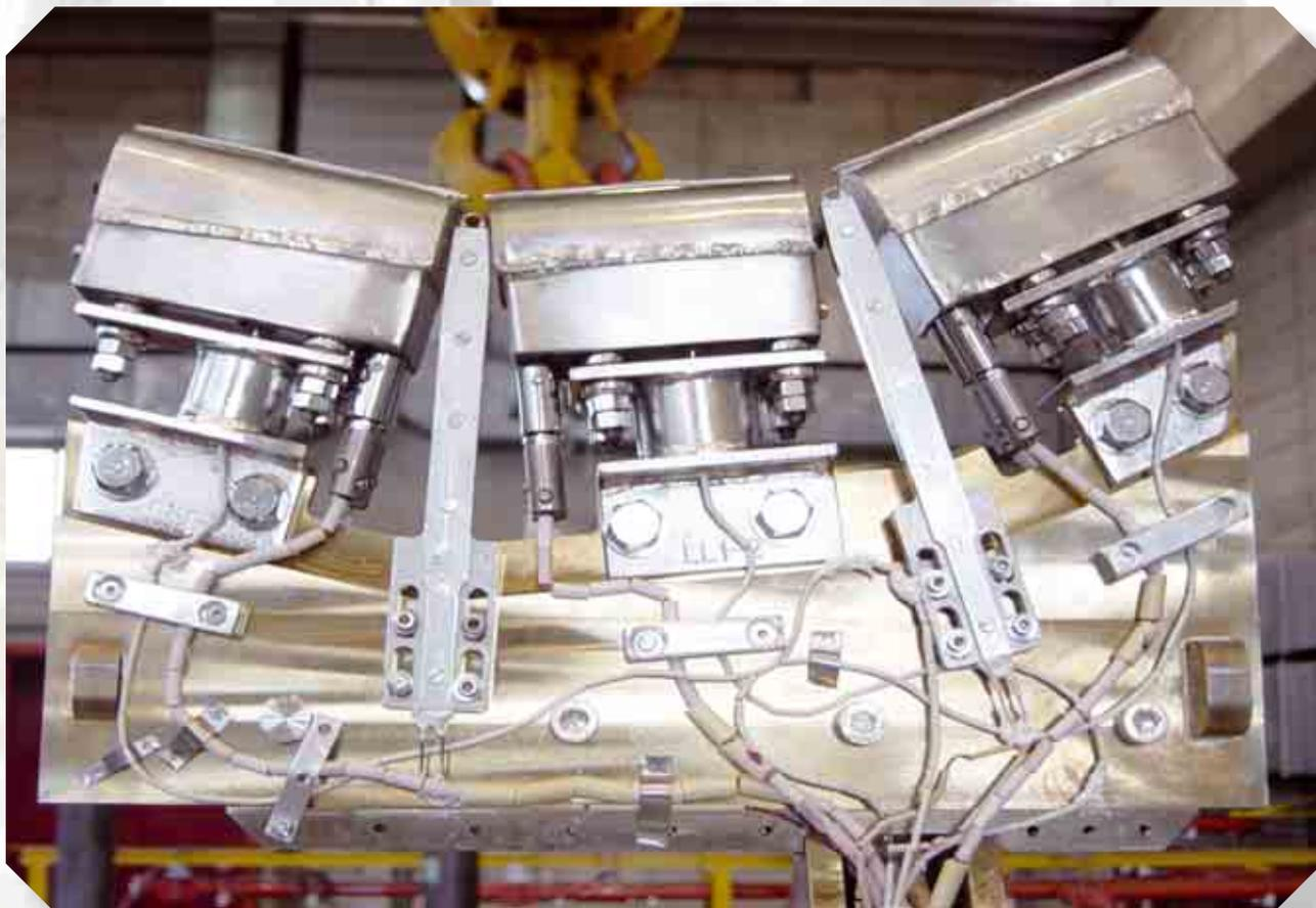
Il limiter di litio prima del montaggio su FTU.
