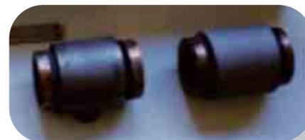
Campioni di componenti per prima parete rivestiti di con strati di tungsteno spessi fino a 5 mm tramite tecniche di plasma spray.
