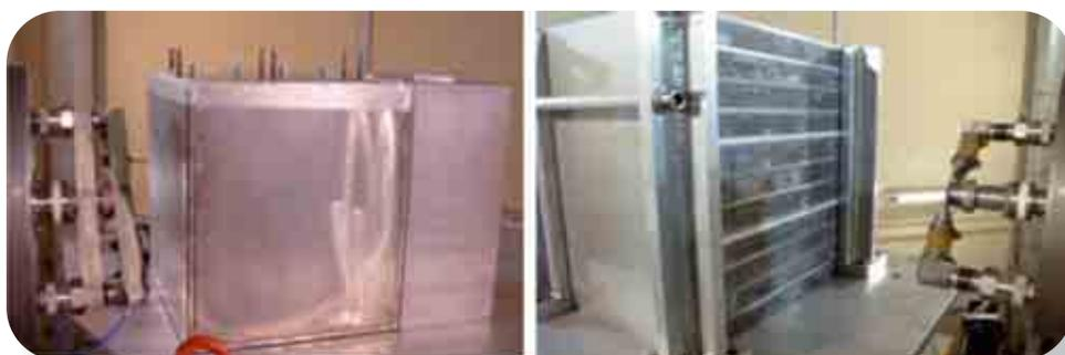
In alto: Esperimento ITER Bulk Shield condotto a FNG per la validazione dei calcoli di attenuazione della densità di flusso neutronico e gamma nel mantello schermante, camera a vuoto e del calore nucleare nel magnete di ITER.
