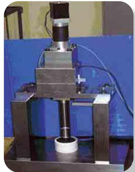
Apparato FIMEC per test ad alta temperatura.
