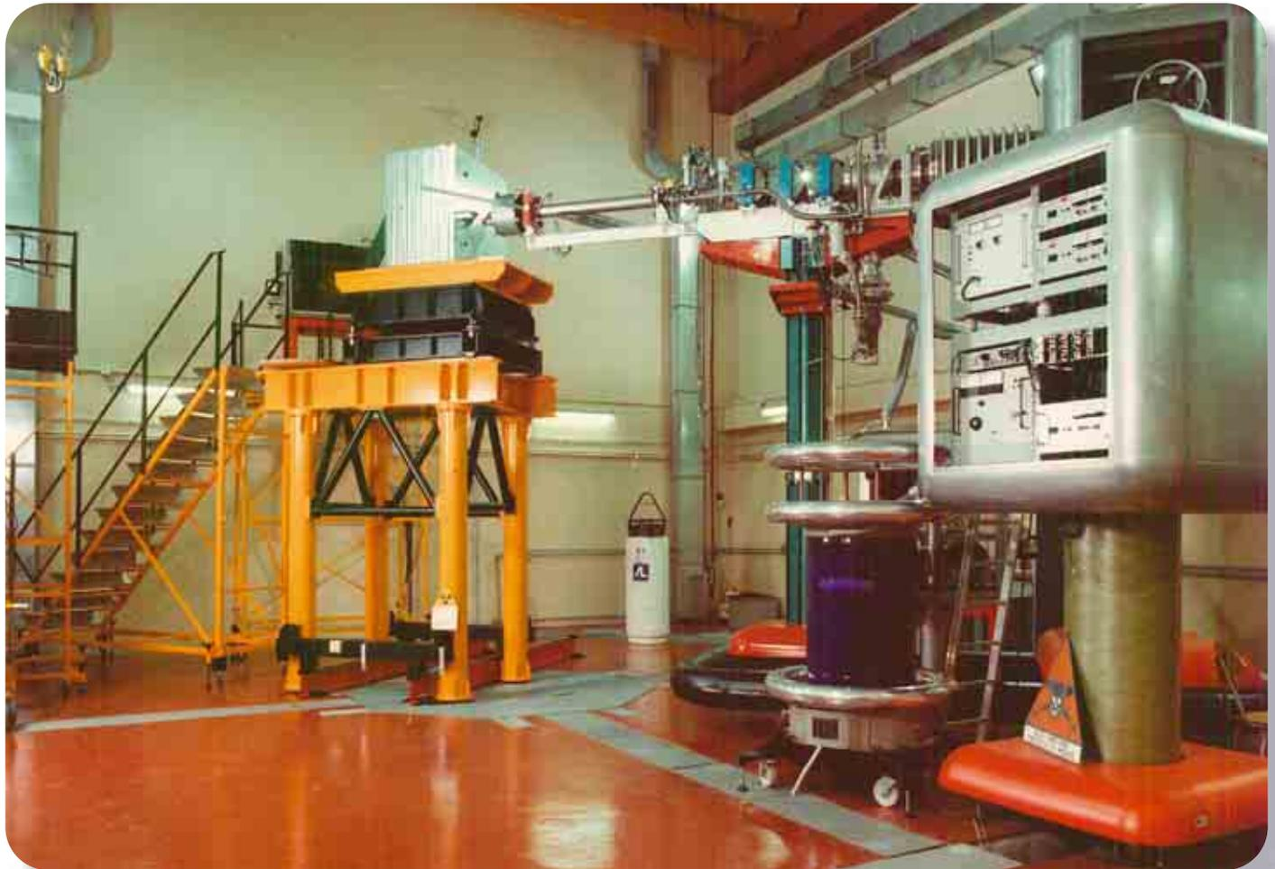
Frascati Neutron Generator. Un prototipo sperimentale è assemblato sopra la torre gialla, davanti al bersaglio di FNG, ed è pronto per essere irraggiato con i neutroni.
