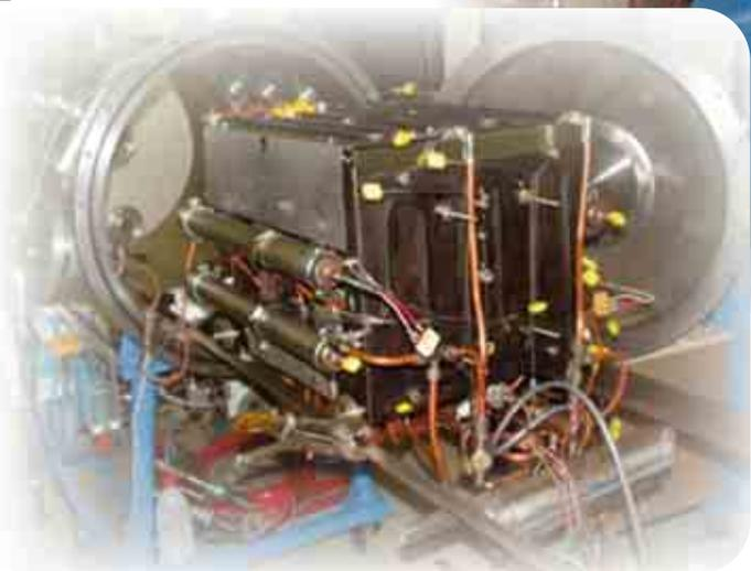
Prove di flusso termico su prototipi di prima parete di ITER rivestiti in berillio.
