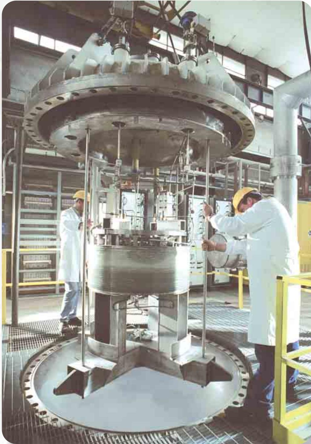
Il magnete di background dell'impianto per la caratterizzazione di cavi-in-condotto.
