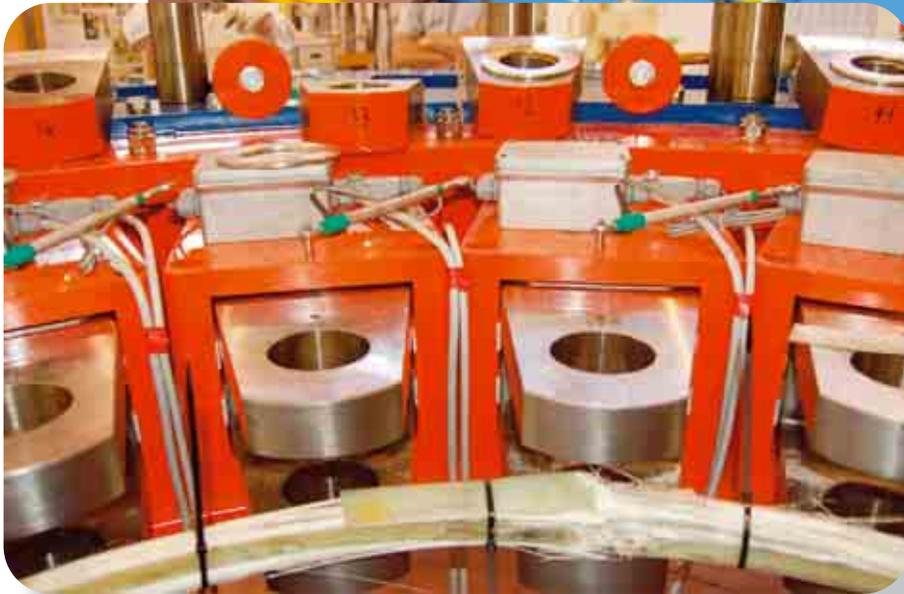
Impianto di prova per gli anelli di serraggio del magnete toroidale. Sotto: particolare dell'impianto con, in evidenza gli anelli, in fibra di vetro.
