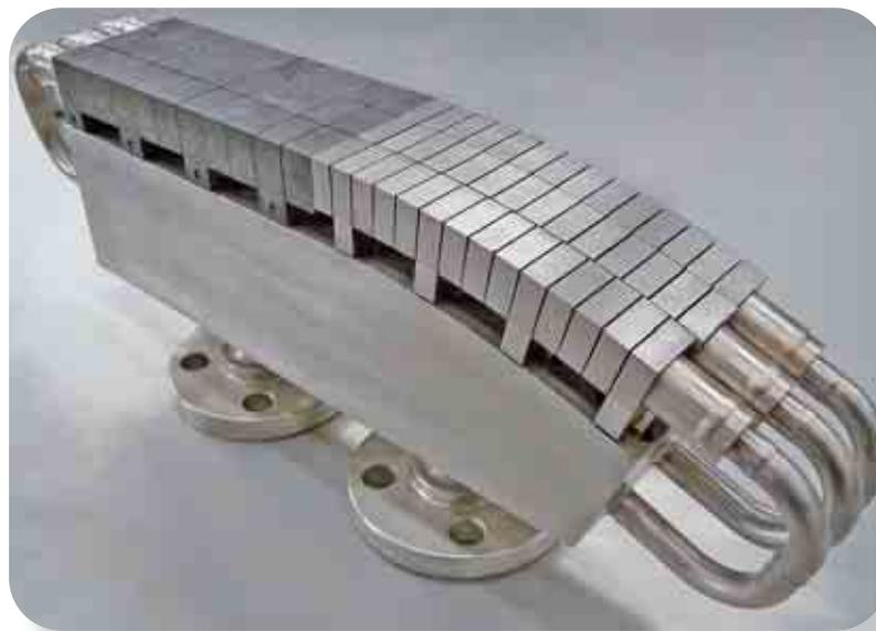
Prototipo di parte del divertore di ITER che ha superato il processo qualifica della tecnologia di costruzione. Costruito con monoblocchi in composito di grafite 3D e monoblocchi in tungsteno attraverso tecniche Pre-Brazed Casting e Hot Radial Pressing. Ha resistito a  $20 \text{ MW/m}^2$  raggiungendo temperature superficiali di  $2000^\circ\text{C}$ . (Prototipo realizzato da Ansaldo su specifiche ENEA).
