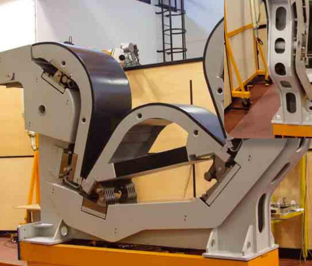
Prototipo della cassetta del divertore di ITER.
