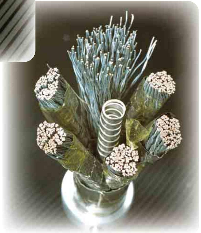
Cavo-in-condotto per i magneti poloidali di ITER (sinistra); particolare del conduttore per il magnete toroidale di ITER (destra).
