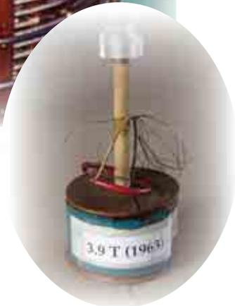
Primo magnete superconduttore prodotto in Italia nel 1963, di 5 mm di diametro interno e campo magnetico di 3.9 T.
