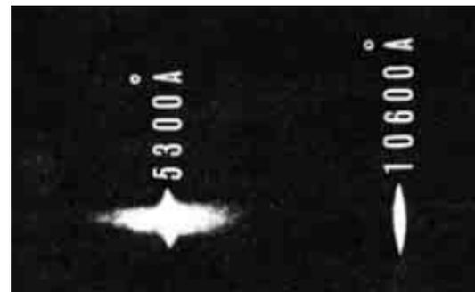
Fig. 4 Emissione di seconda armonica generata dal plasma di un bersaglio irraggiato in Hot-Ice negli esperimenti con impulsi ultra-corti (1970).
