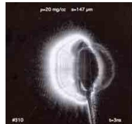
Fig. 4 Shadografia in campo scuro di un foglio di polistirene (rappresentato nella posizione iniziale dal curva azzurra) irradiato da un fascio di ABC trattato con la tecnica ISI. Il bersaglio aveva una massa per unità di superficie comparabile con quella dei bersagli rappresentati in Fig. 2.
