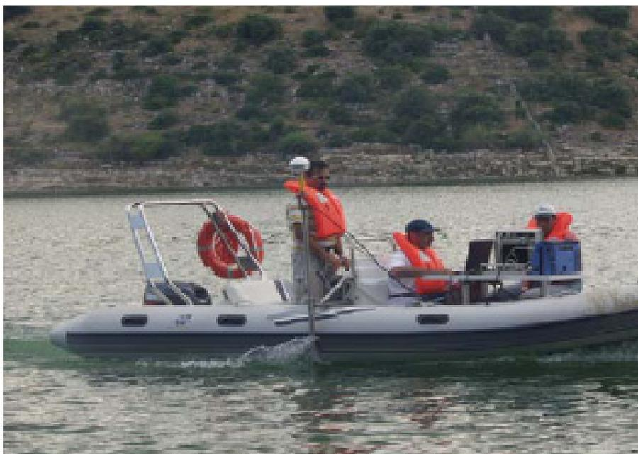
**Figura 19 – Strumentazione di bordo (PC portatile ed ecoscandaglio)**
