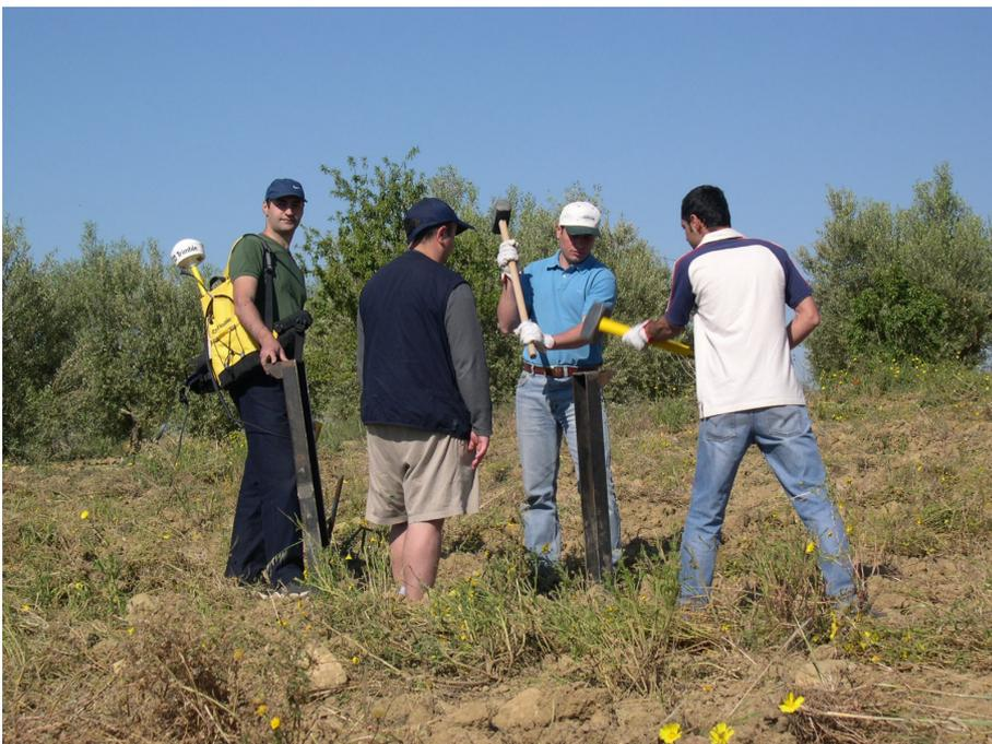
**Figura 12 – Estrazione del carotiere**
