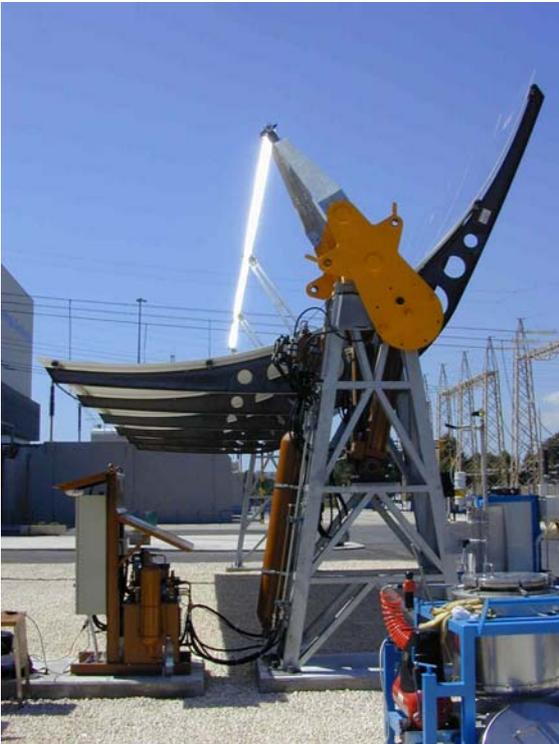
*Fig. 21 - Sistema di movimentazione dei collettori*
