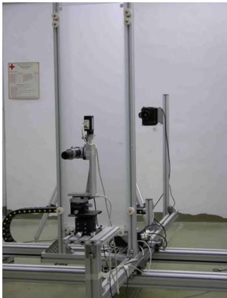
*Fig. 36 – Vista del profilometro ottico e del castello di fissaggio specchi in prova*
