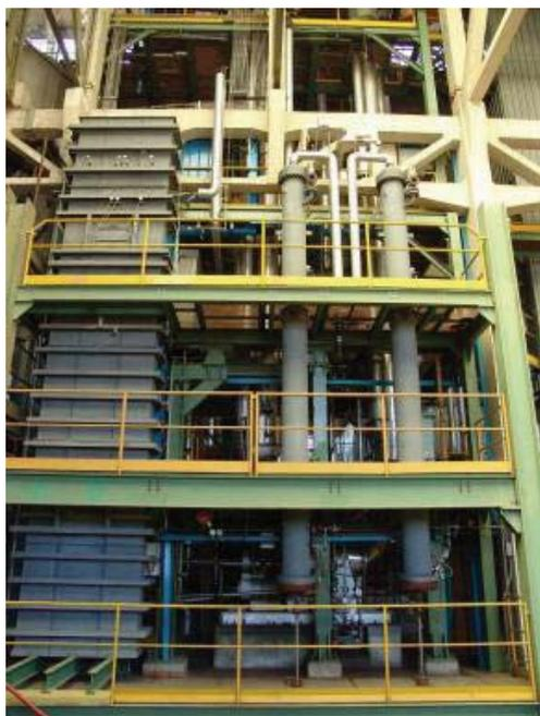
**Fig. 4.8 – Vista 3D della facility SPES3 che simula la termo-fluidodinamica del Reattore IRIS**
