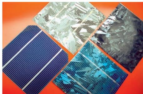
policristallino, opportunamente drogato. Essa è generalmente di forma quadrata e di superficie pari a circa 100  $\text{cm}^2$  (anche fino a 400  $\text{cm}^2$ ) e si comporta come una minuscola batteria, producendo, nelle condizioni di soleggiamento standard (1  $\text{kW/m}^2$ ) e a 25  $^\circ\text{C}$ , una corrente di 3 A con una tensione di 0,5 V, quindi una potenza di 1,5 W.
