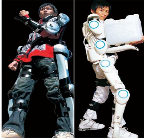
**Fig. 17 - Il robot HAL indossato**
