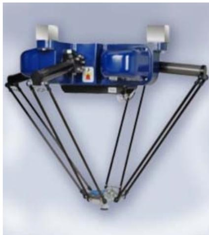
**Fig. 18 - Robot parallelo "Adept Quattro"**
