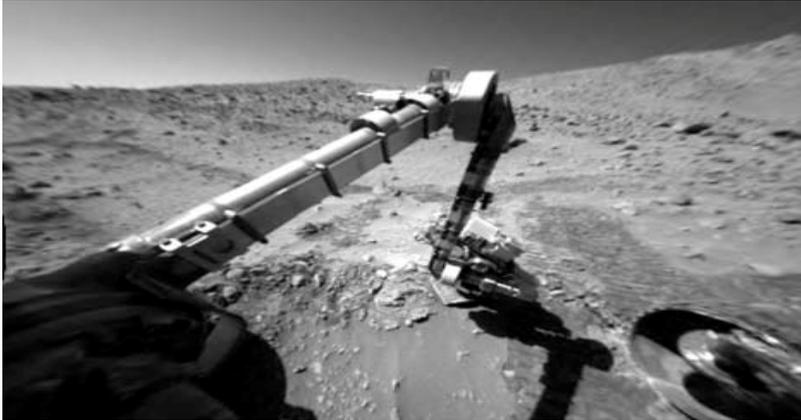
**Fig. 7 – Il robot “Rover”, dedicato all’esplorazione in ambienti non strutturati e al campionamento di materiali e sostanze, in azione su Marte [2.2]**
