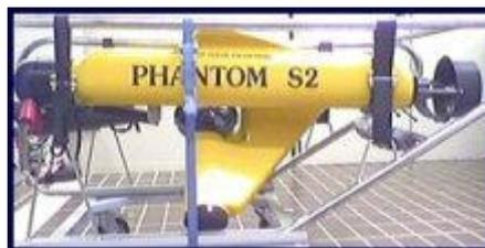
**Fig. 54 - Phantom per il controllo degli oleodotti sottomarini (Prog ISME)**
