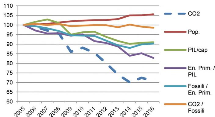
Figura 25 – Emissioni di CO<sub>2</sub> in Italia e suoi driver (equazione di Kaya, indici 2005=100)
