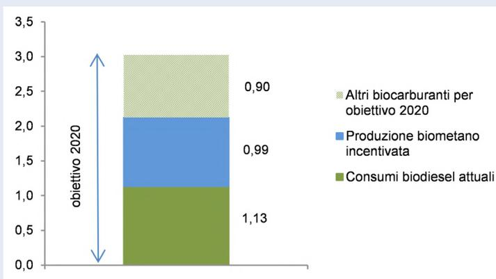
**Figura 50 – Produzione di energia primaria per il raggiungimento del target 2020 per i trasporti: consumi di biodiesel, quantità di biometano massima incentivabile, copertura residua da assicurare con biocarburanti (Mtep)**
