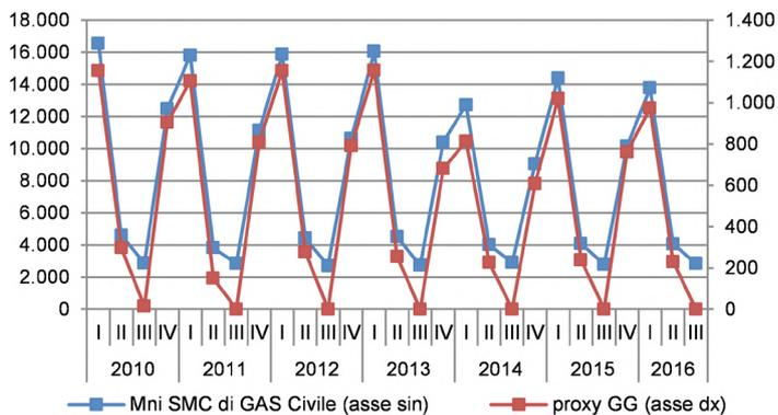
Figura 18 – Consumi di gas naturale nel settore civile (MSm<sup>3</sup> asse sin) e proxy Gradi Giorno riscaldamento (asse dx)
