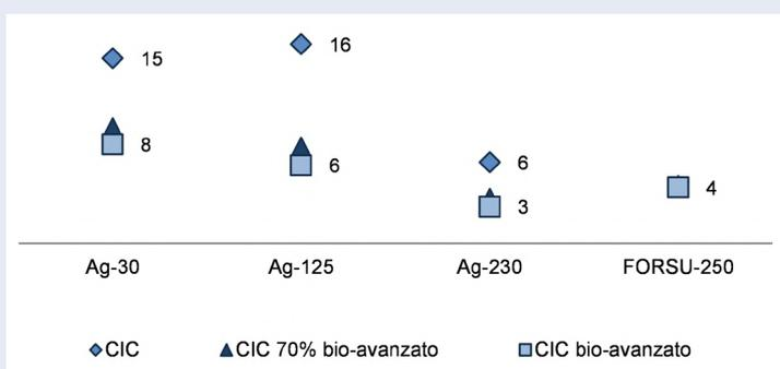
**Figura 53 - TRI (anni) per immissione del biometano mediante distributore proprio (Ag=impianto che tratta matrici agroindustriali, il numero è la capacità produttiva m<sup>3</sup>/h)**
