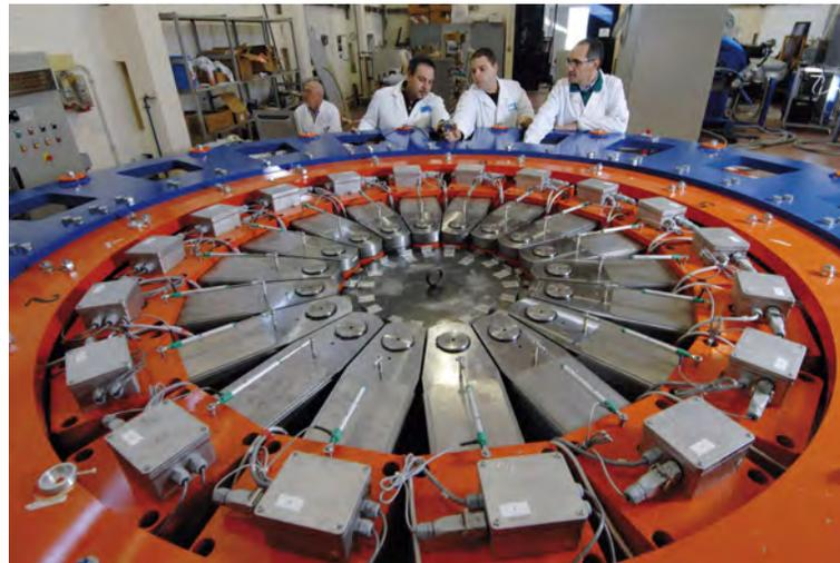
*Macchina per il test degli anelli di ITER
