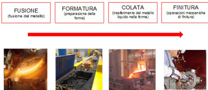
Figura 4 - Le principali fasi del processo di fonderia con formatura "a perdere" in sabbia.
