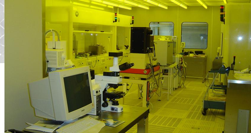
Lavorazioni fotolitografiche di film sottili in camera pulita
