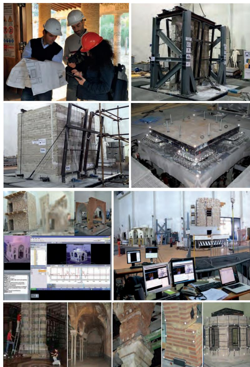
si tratta di un sistema optoelettronico (3D Vision) con sistema di telecamere (NIR) ad alta risoluzione, in grado di rilevare gli spostamenti nello spazio delle strutture sottoposte alle azioni sismiche.
