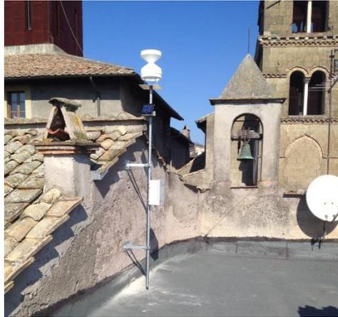
Figura 58. Stazione pluviometrica di Formello
