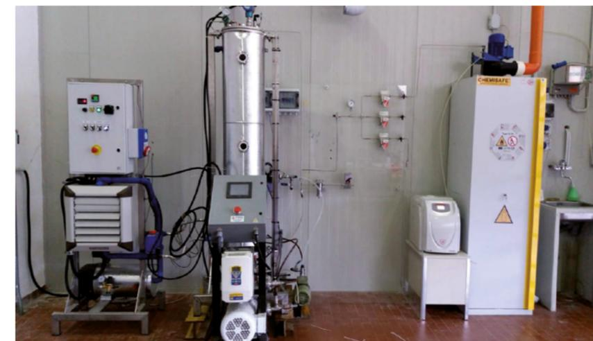
BioUP50 – Impianto di upgrading biologico del biogas
