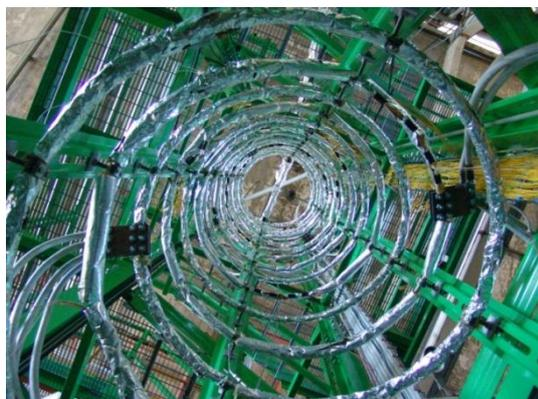
*Impianto IETI per prove di scambio termico su tubi elicoidali*
