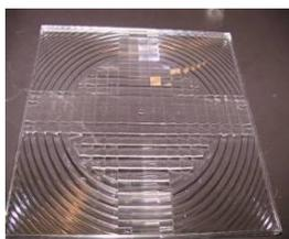
Il *concentratore ottico* è una lente prismatica rifrattiva realizzata in materiale acrilico, in grado di concentrare di 200 volte la radiazione solare su una cella fotovoltaica di 1 cm<sup>2</sup>, posta ad una distanza di circa 20 cm, con un profilo di distribuzione della luce concentrata molto uniforme. Il brevetto risponde alle esigenze di avere un prodotto a basso costo adatto ad essere fabbricato in serie. I prototipi sono stati realizzati in collaborazione con Borromini.
