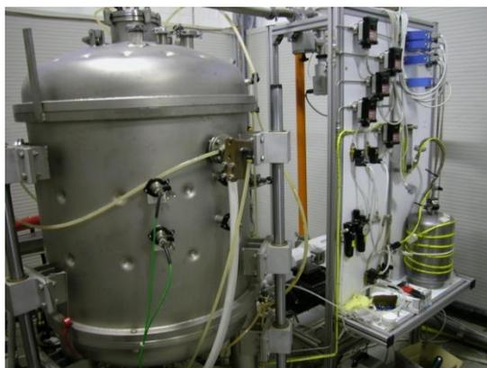
Impianto per Chemical Vapour Infiltration (CVI) della FN SpA
