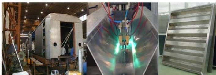
*Saldatura di pannelli sandwich*
