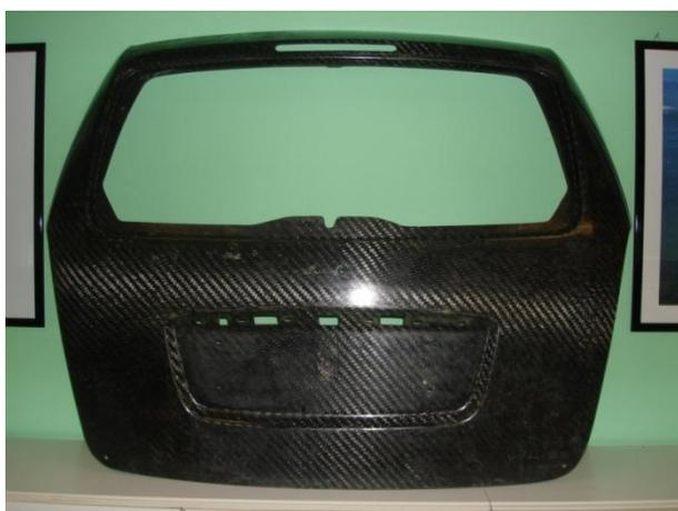
Portellone posteriore autovettura realizzato in fibra di carbonio in resina epossidica. Progetto TRASPORTI (*finanziamento PON 2007-2013, DM 24440*)
