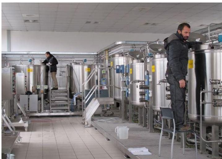
*Il processo brevettato prevede l'aggiustamento in campo acido del pH delle acque di vegetazione appena generate, un trattamento di idrolisi enzimatica seguito da una separazione per centrifugazione, e successivi trattamenti con tecnologie separative a membrana delle correnti di permeato via via ottenute, consistenti in microfiltrazione, ultrafiltrazione, nanofiltrazione e osmosi inversa.*
