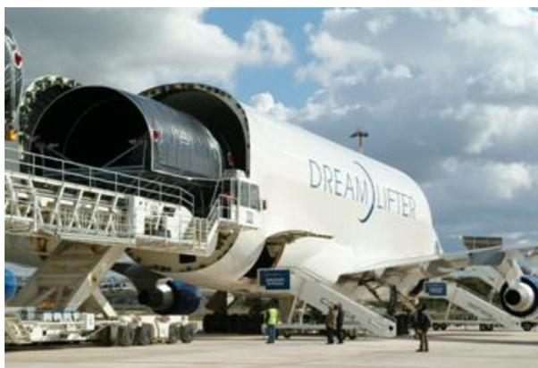
Grottaglie (ITA)- Carico della sezione centrale e posteriore della fusoliera del Boeing 787 Dreamliner
