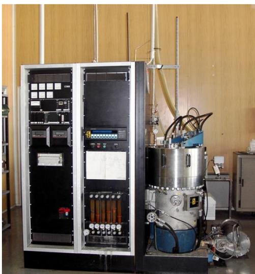
Forno della FN SpA per gas pressure sintering (max 100 bar pressione, T max 2200 °C) impiegato per il casting del rame su tungsteno
