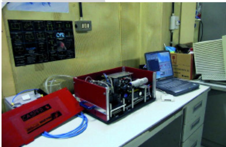
Spettrofluorimetro laser compatto per l'analisi della qualità delle acque
