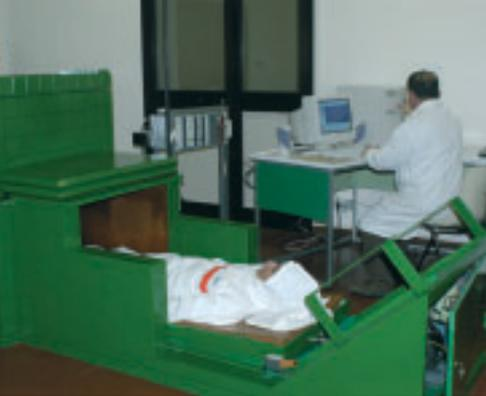
Whole Body Counter del tipo shadow shield a tunnel con lettino mobile e rivelatore NaI(Tl)
