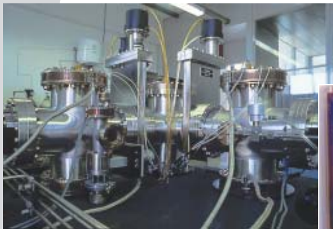
Primo sistema tricamera per la deposizione di silicio amorfo mediante scarica a bagliore, operativo nel Centro dal 1990 (a sinistra) e prove di deposizione (a destra)
