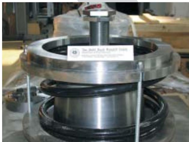
*Isolatore sismico 3D del sistema di supporto realizzato dall'ENEA*
