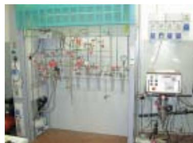
*Particolare della linea di sintesi del laboratorio di analisi C<sub>14</sub>*
