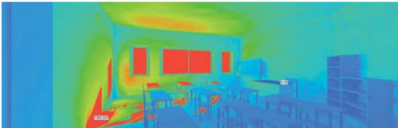
*Impiego di modelli di simulazione per il controllo della efficacia dell'utilizzo della luce naturale in un sistema di illuminazione ibrido*
