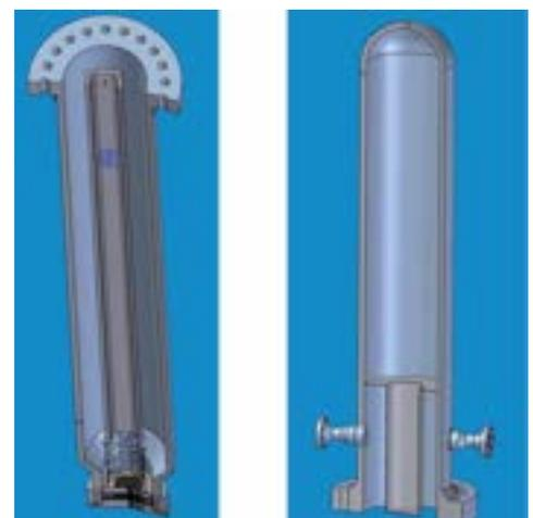
Sezione del fondo e della parte alta del vessel di SPES-3
