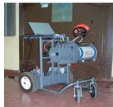
*Strumento portatile per misura gamma*
