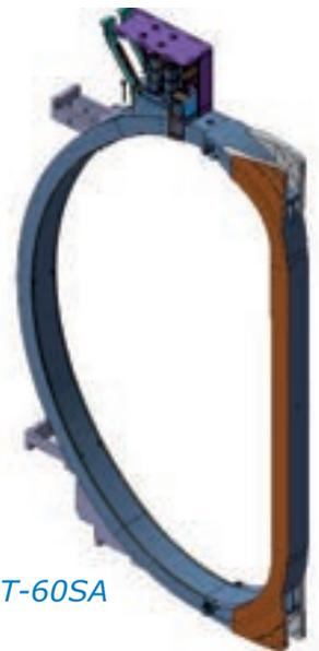
Vista della bobina toroidale di JT-60SA
