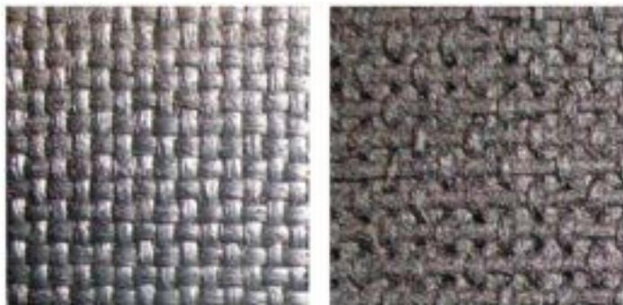
**Figura 38. Campioni SiC/SiC con architetture 2D e 3D**
