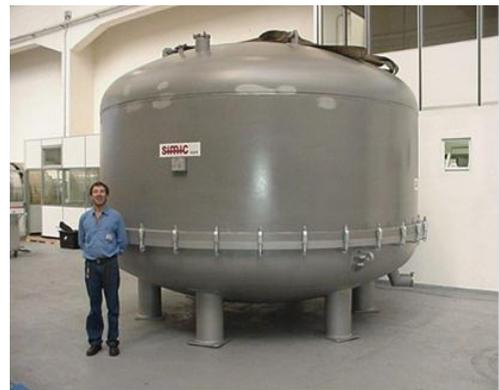
Figura 11. Camera da vuoto per la preparazione del conduttore
