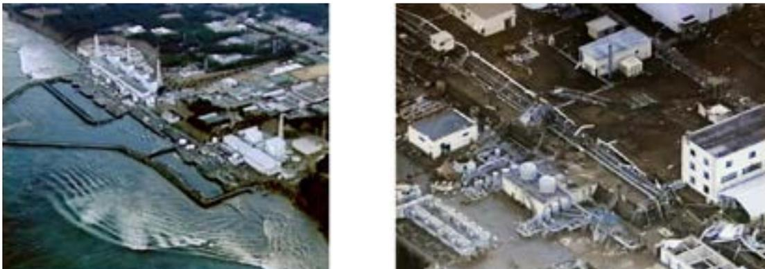
Figura 6. Immagini del sito subito dopo lo tsunami: riflusso dell'acqua dopo l'inondazione (sinistra) e dettagli delle strutture antistanti al complesso danneggiate dalle onde (destra)
