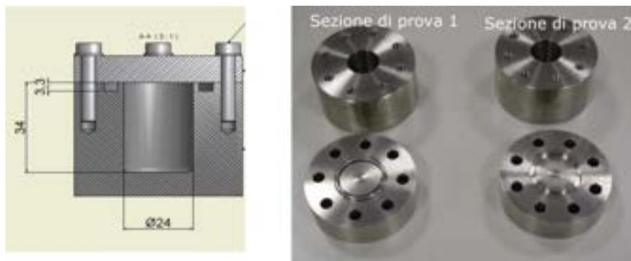
**Figura 32. Progetto della sezione di prova e sezioni realizzate**
