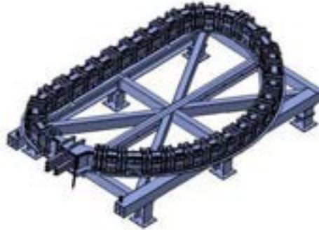
**Figura 15. Stampo di impregnazione della bobina toroidale completo di staffe di pressatura**
