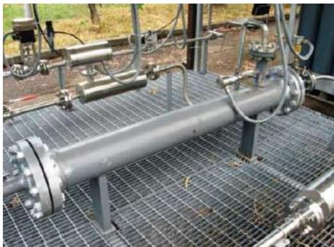
Cartridge di contenimento del modulo a membrane
