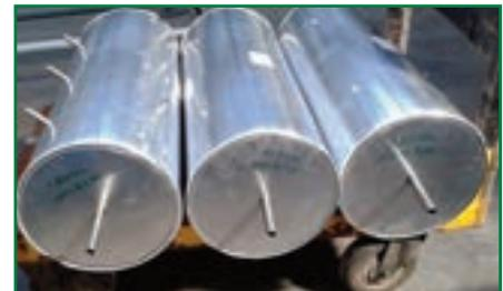
*Impianto per il test di elementi di accumulo a calore latente: vista dell'impianto ed alcuni componenti (termostato di circolazione, tubo alettato, elementi di accumulo)*
