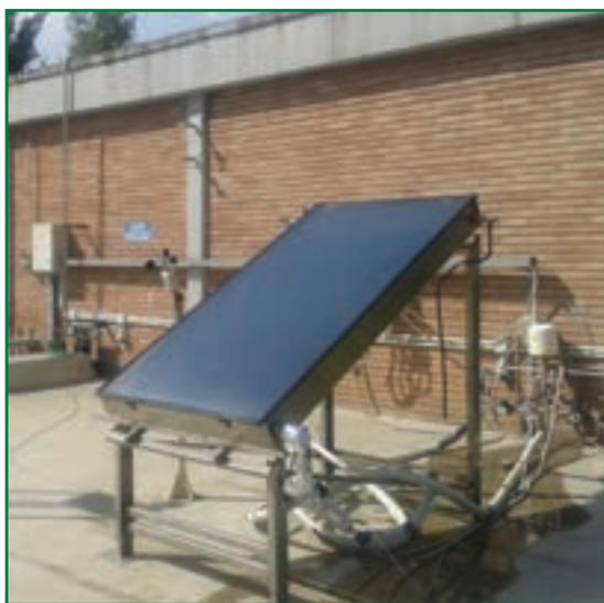
*Prototipo collettore solare termico: test preliminari*
