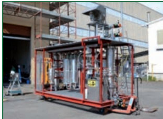
*Impianto di produzione di gas sintetico GESSYCA*
