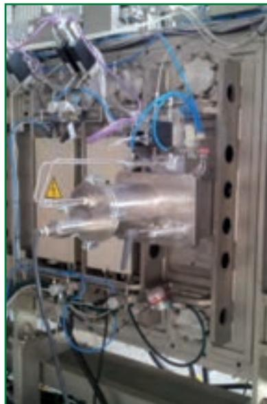
*Sezione di deposizione dell'impianto di sputtering ENEA: in primo piano l'interflangia per l'installazione della sorgente ionica KRI EH200/MHC1000*
