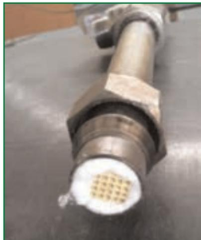
*Monolite con  $V_2O_5$  per l'ossidazione selettiva dell' $H_2S$*
