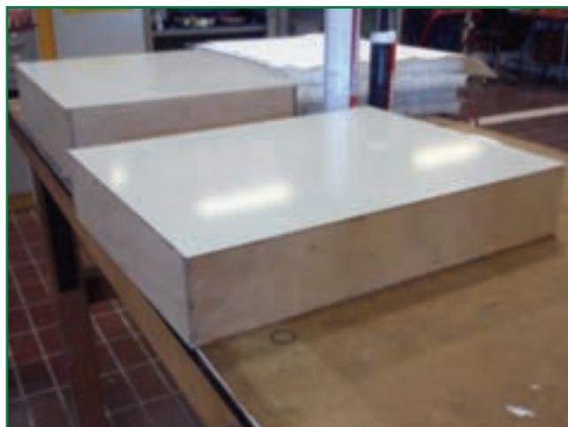
*Prototipo di pannello multistrato contenente materiale PCM*
