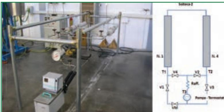
*Circuito SOLTECA per il test di elementi di accumulo termico in calcestruzzo*
