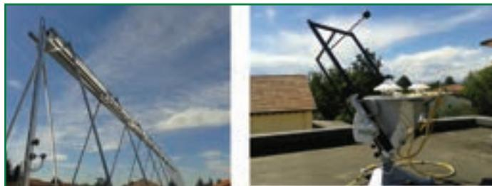
*installazione su cui sono state eseguite le sperimentazioni in campo e relativo dettaglio dell'apparecchiatura utilizzata per il monitoraggio della radiazione solare*
