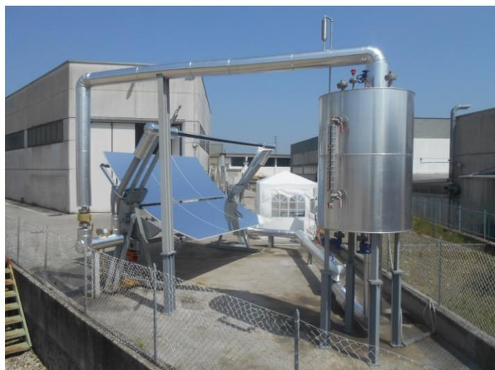
*Figura 69 - Impianto sperimentale per la caratterizzazione del modulo base Ronda HT*
