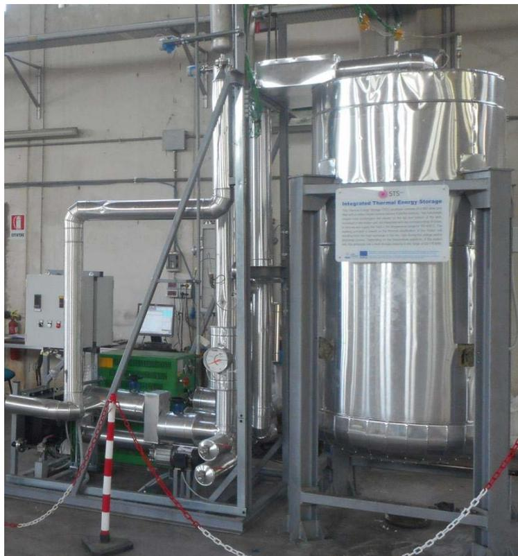
*Figura 32 - Prototipo di Sistema di accumulo termico per STS-Med*
