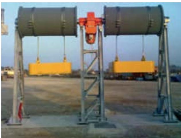
Figura 72 - Collettore DD: apparato per le prove di funzionamento del sistema di movimentazione
