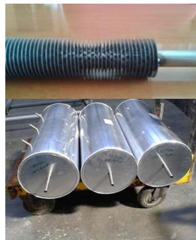
Figura 56 - Configurazione "Shell and tube":
