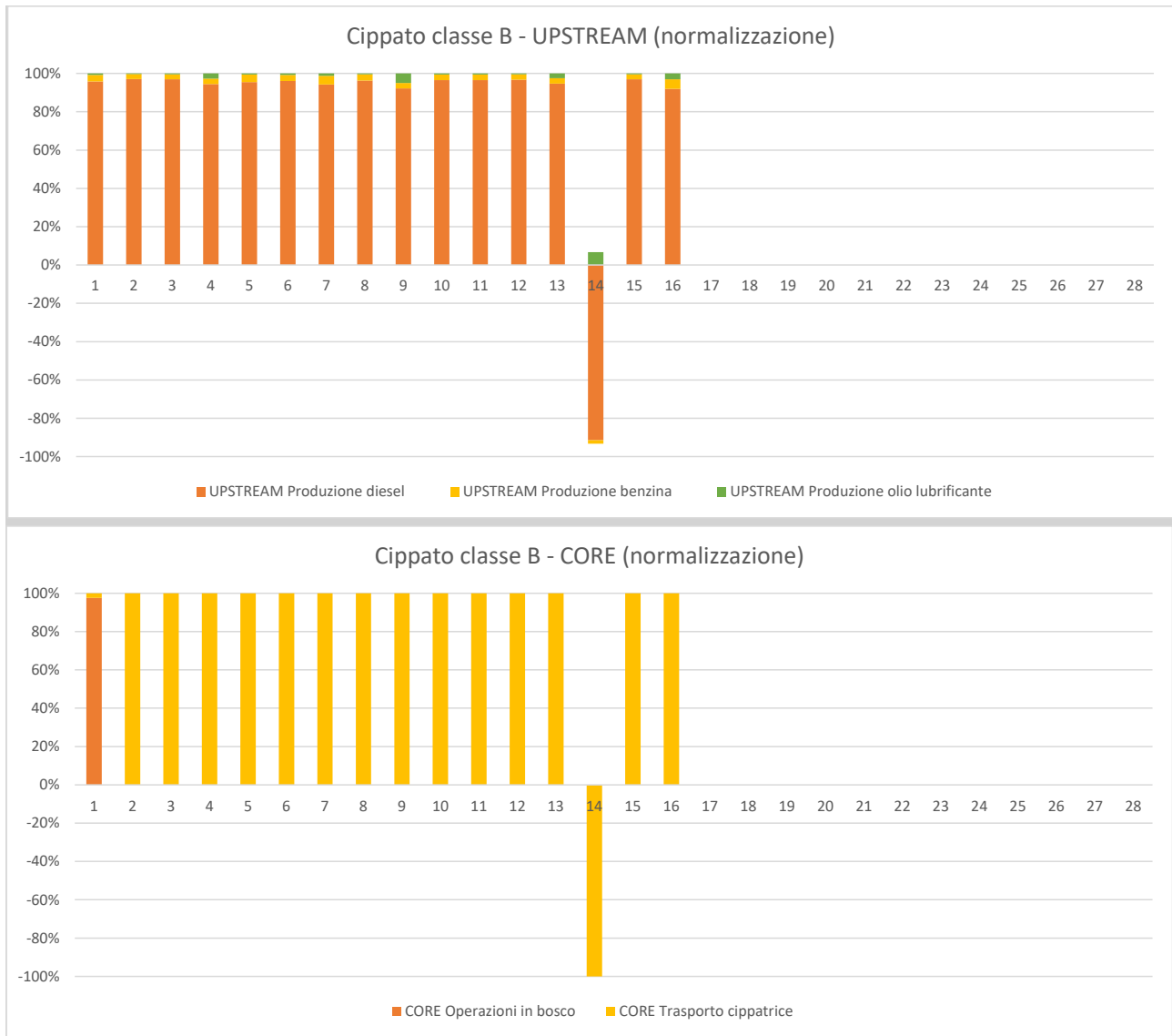
Figura 7 – Cippato di classe B – Normalizzazione: contributo processi all’impatto delle fasi UPSTREAM e CORE
