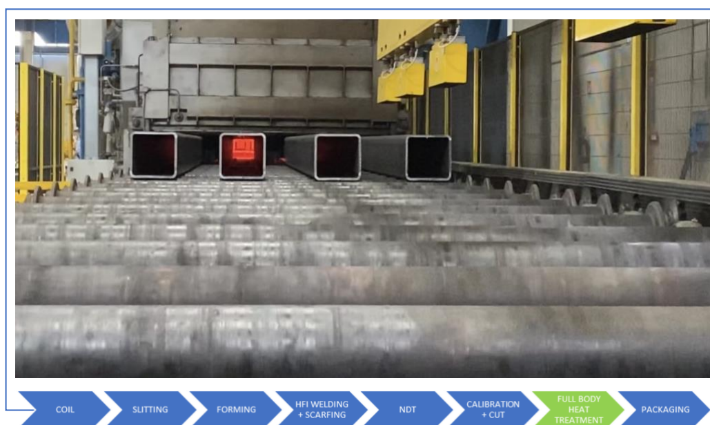
Figura 7 – Profili cavi, quadri e rettangoli normalizzati (HFS) dell’azienda Arvedi Tubi Acciaio
