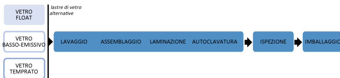
Fig. 3.1.4. Processo di produzione del vetro stratificato. Fonte: Elaborazione PoliMi.
