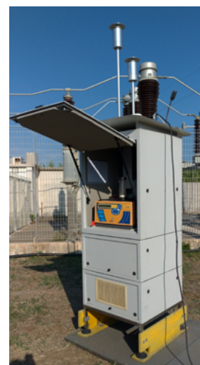
Cabina di campionamento di PM10 su filtro in campagna di misura.
